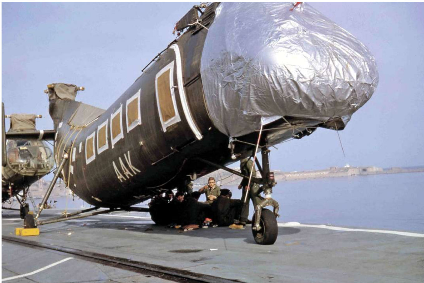
H-21 n°49/AAK, du 14 e GALAT, à bord du porte-avions "Arromanches". Le navire appareille le 14 janvier 1964 de Mers-el-Kébir à destination de Toulon où il arrive le lendemain. La "Banane" a toutes ses ouvertures calfeutrées pour se protéger de la salinité de l'air marin (photo Yves Gelebart).
